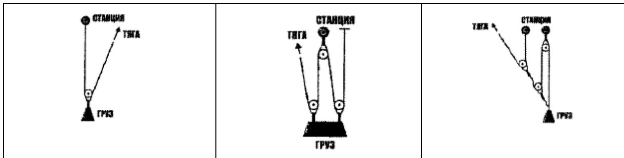
На грузовом канате выше тягового зажима должен быть установлен зажим для ограничения обратного хода конца каната, на котором закреплен груз. В плане производства работ с учетом оценки рисков может быть разрешено использование вместо зажима самозатягивающегося узла.
