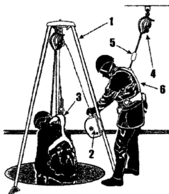
Система спасения и эвакуации, использующая переносное временное анкерное устройство и встроенное спасательное подъемное устройство;
