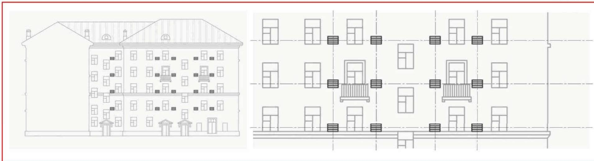
Пример правильного размещения кондиционеров на внутривором фасаде
