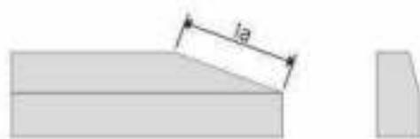
Длину аппарели ( $l_a$ ) при тротуарных покрытиях из сборных плит принимают кратной размеру плит, а другие размеры — в зависимости от марки камня. Серия: ГОСТ 6665-91
